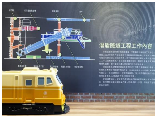
閱讀牆解說潛盾機以轉動前方切刀盤方式鑽掘土石
