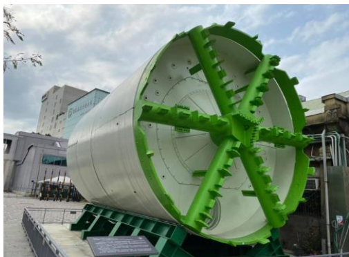
實體潛盾機是一種專門用來開鑿隧道的大型機具
